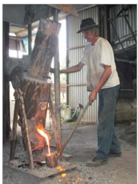
À l'aide de son mini cubiloteur, Alain Adin réalise des poutres techniques.
