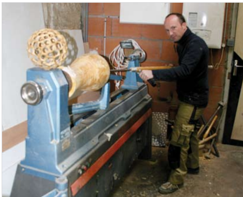
Grâce au tour à bois, Sébastien Panis réalise des prouesses : d'une bûche il réalise une sphère évidée.
