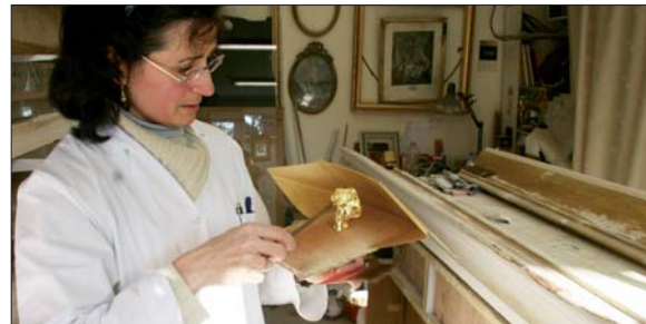
Les feuilles d'or de quelques microns d'épaisseur sont posées une à une.
