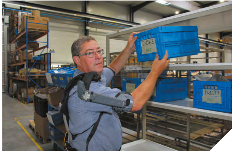
Benoît Sagot-Duvauroux, responsable activité GOBIO, équipé de l'IP12 qui permet de travailler les bras en l'air. GOBIO est une marque de GEBE2 intégrée au groupe Europe Technologies.
