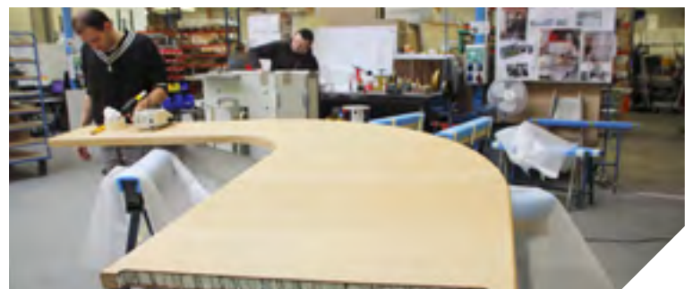
Un élément du bar du TGV Paris-Bordeaux en cours de fabrication dans l'usine SMTC.
