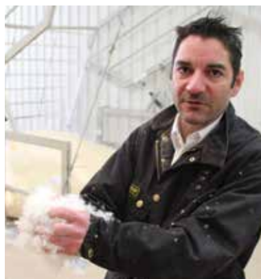
La qualité du duvet se mesure à son pouvoir de résilience. Une poignée de duvet maintenue dans une main retrouve son ampleur originelle en quelques secondes.
