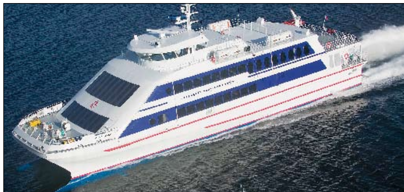
Son système de stabilisation permet au Pont-d'Yeu d'annuler l'effet de roulis.
