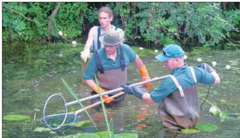
L'électrode, constituée d'un long manche et d'un cercle métallique, permet d'attirer les poissons.
