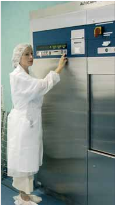
L'autoclave permet de désinfecter les objets à 134° pendant 18 minutes.
