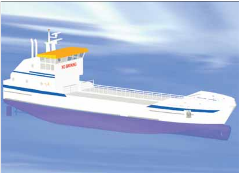
Long de quarante et un mètres, le nouveau navire pourra transporter 310 m³ de fioul.
