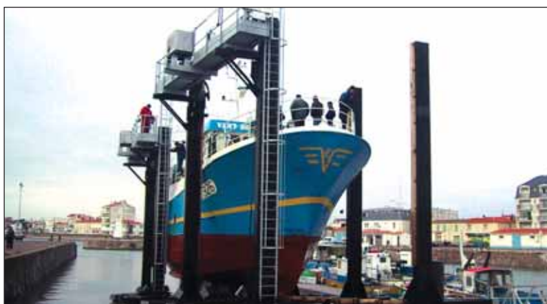
Le Slipway permet de sortir de l'eau des bateaux de 250 tonnes pour faciliter les réparations.
