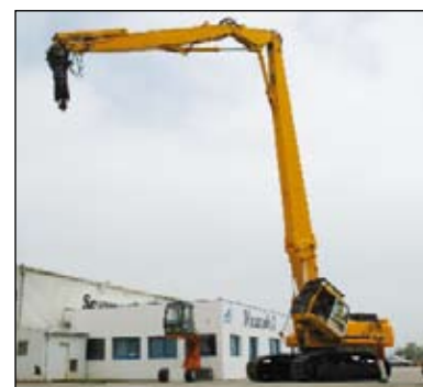
La première pince de démolition d'une portée de 27 mètres créée par Mécanokit : sa cabine inclinable à 30° facilite les manœuvres du conducteur.
