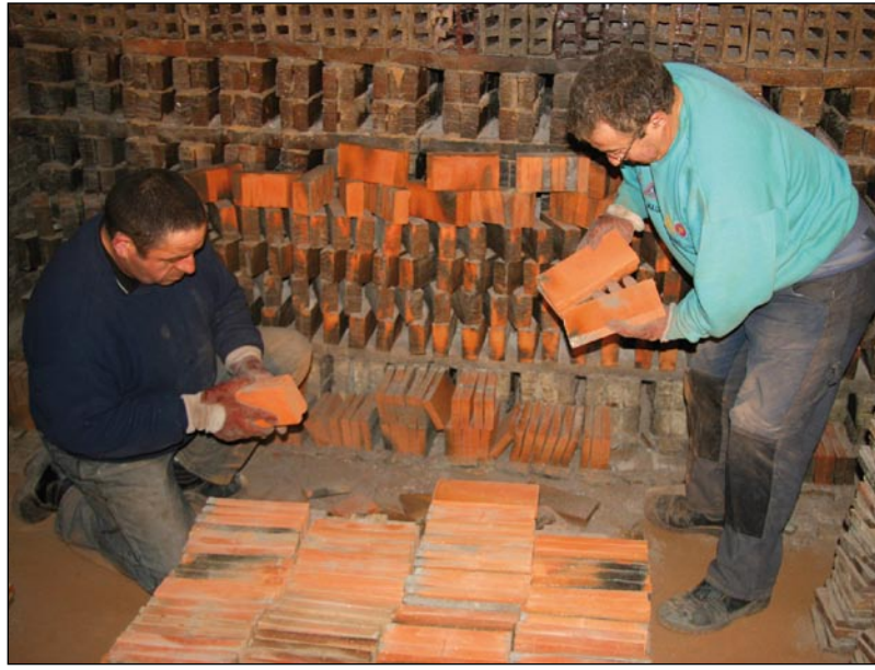
La fabrication de briques et de carreaux de terre cuite est toujours une activité manuelle.
