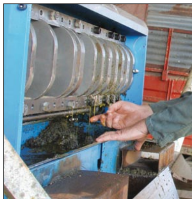
La presse à huile permet de produire du carburant et de la nourriture animale.
