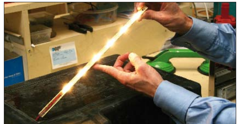
Les LED (diodes électroluminescentes) sont collés sur le vitrage des devantures réfrigérées.
