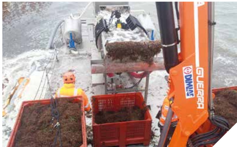
Mis en place par l'entreprise Thomsea, l'Amadeus est muni d'un système qui permet de pêcher les algues rouges.
