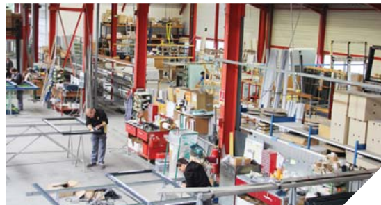
Dans l'atelier de l'entreprise Secom Alu, les menuisiers coupent et assemblent les pièces que d'autres équipes mettront en place.
