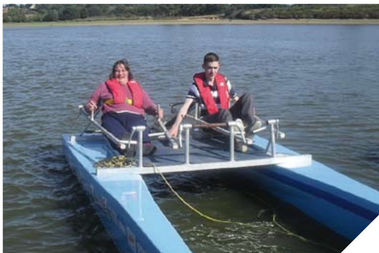
L'handicata se manie à l'aide de pédales rattachés à la godille.
