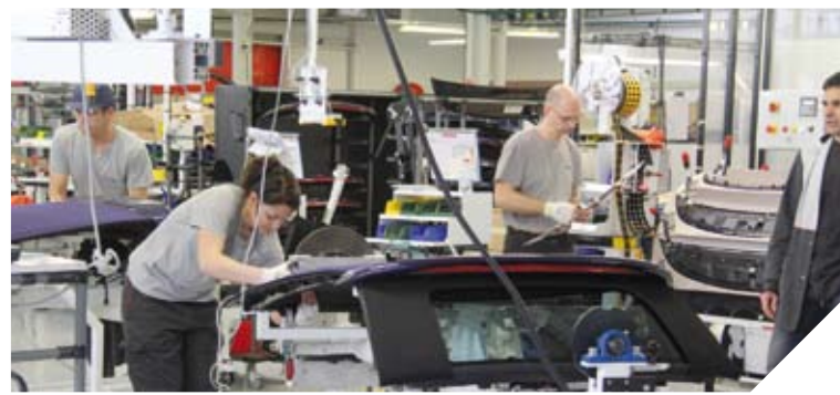
L'entreprise vendéenne webasto fabrique le toit de la DS 3 cabrio sur une ligne spécifique.
